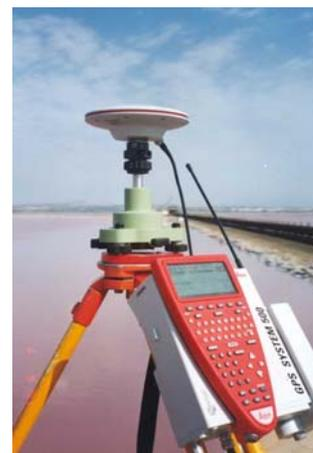
La antena es el elemento al cual viene siempre referido nuestro posicionamiento, está conectada a través de un preamplificador al receptor, directamente o mediante cable. La misión de la antena es la de convertir la energía electromagnética que recibe en corriente eléctrica que a su vez pasa al receptor.
