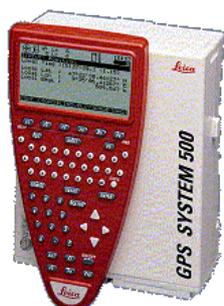
Trabajan en tiempo real o en post-proceso alcanzando precisiones del orden de 5mm.+1ppm y disminuyendo los tiempos de observación.
