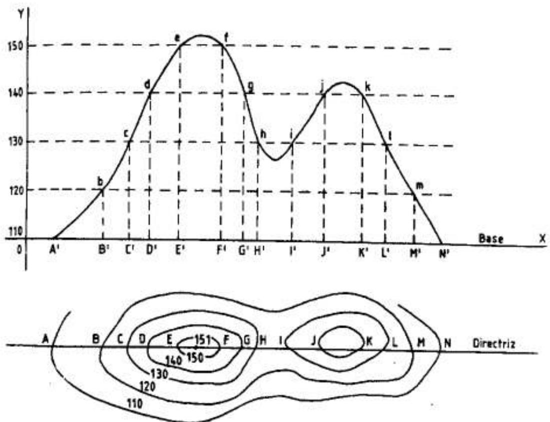
Fig. 5.15. — Perfil de un terreno.
