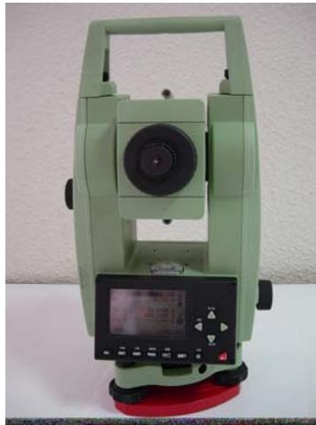
Una estación total permite efectuar las mismas operaciones que se efectúan con otros aparatos como los taquímetros y teodolitos incorporando las nuevas técnicas de la electrónica y la informática.
