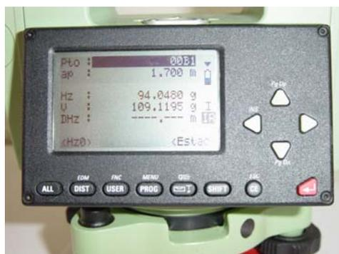
Con una estación total se podrá determinar: la distancia horizontal o reducida, la distancia geométrica, el desnivel, los ángulos horizontales y verticales, así como las coordenadas X,Y,Z.
