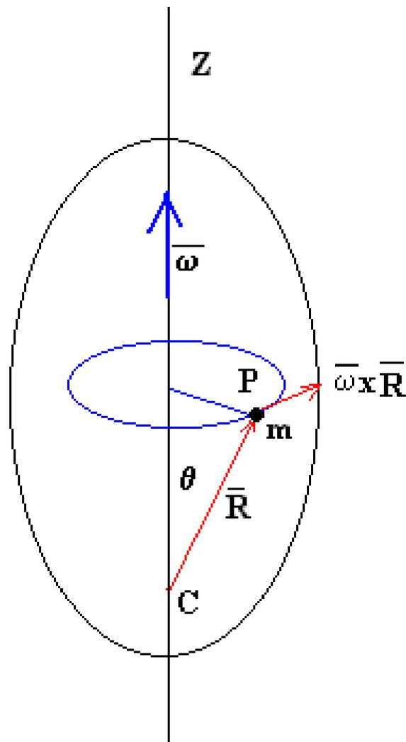
Todos los puntos del sólido giran con la misma velocidad angular  $\vec{\omega}$
