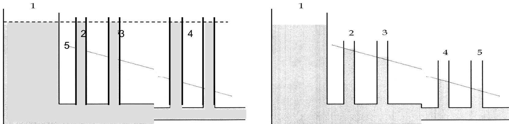
Según Bernouilli, si un fluido ideal circula por una tubería horizontal de sección constante, la presión en todos sus puntos (2, 3, 4 y 5) es la misma. Cuando el fluido es viscoso hay pérdida de presión y en los puntos 2 y 3 (la sección es la misma) no hay la misma presión, y en los puntos 4 y 5 tampoco
