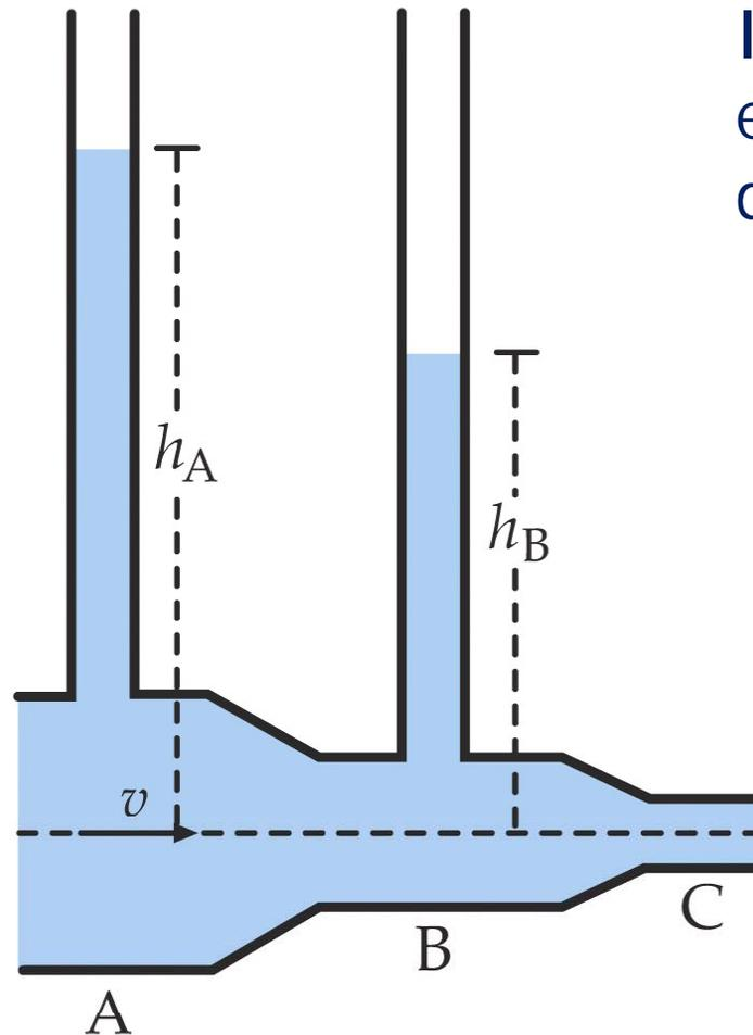
Insertamos unos tubos piezométricos en dos puntos situados en secciones distintas
