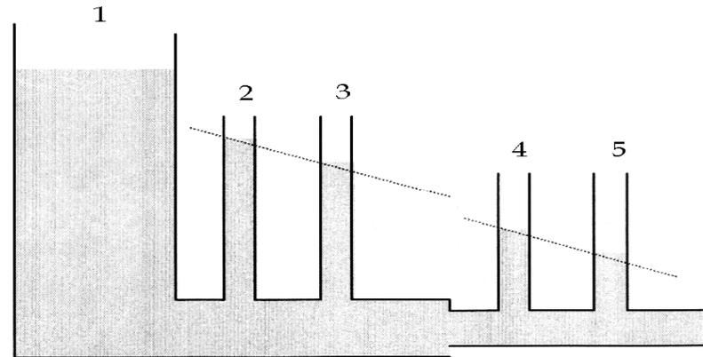
Según Bernouilli, si un fluido ideal circula por una tubería horizontal de sección constante, la presión en todos sus puntos es la misma. Cuando el fluido es viscoso hay pérdida de presión y en los puntos 2 y 3 (la sección es la misma) no hay la misma presión, y en los puntos 4 y 5 tampoco
