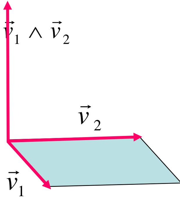
Es un vector: Módulo es el producto de los módulos por el seno del ángulo que determinan; la dirección, perpendicular a ambos vectores y el sentido se determina por la regla de la mano derecha
