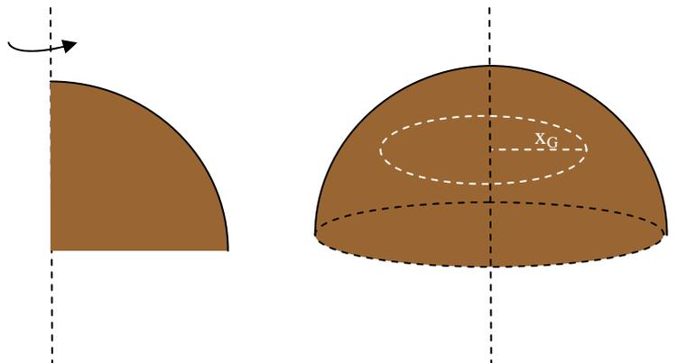
$\frac{2}{3}\pi R^3 = (2\pi y_G) \left( \frac{\pi R^2}{4} \right)$  de forma que la coordenada  $y$  del centro de gravedad es  $y_G = \frac{4R}{3\pi}$
