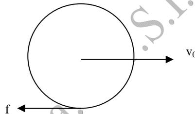
Debido a que el cuerpo gira en torno al eje  $GZ$ , se cumple la ecuación fundamental de la dinámica de rotación  $I_{GZ} \varphi'' = Rf$ , por tanto  $\frac{2}{5} MR^2 \varphi'' = Rf$  de donde la aceleración angular es  $\varphi'' = \frac{5f}{2MR}$ . Esa es la aceleración angular mientras no se cumpla la condición de rodadura
