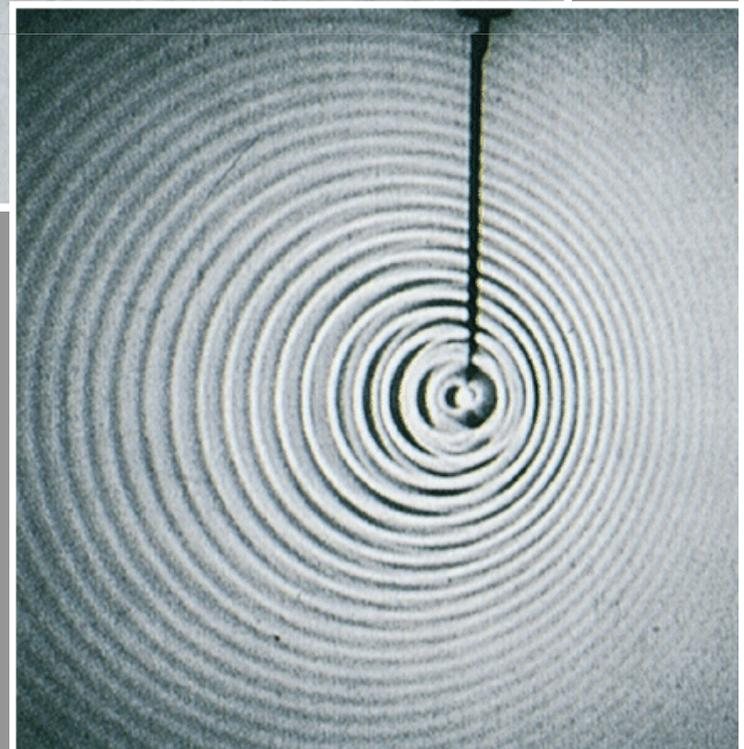
Frentes de onda circulares alejándose de un foco puntual en una cubeta de ondas
