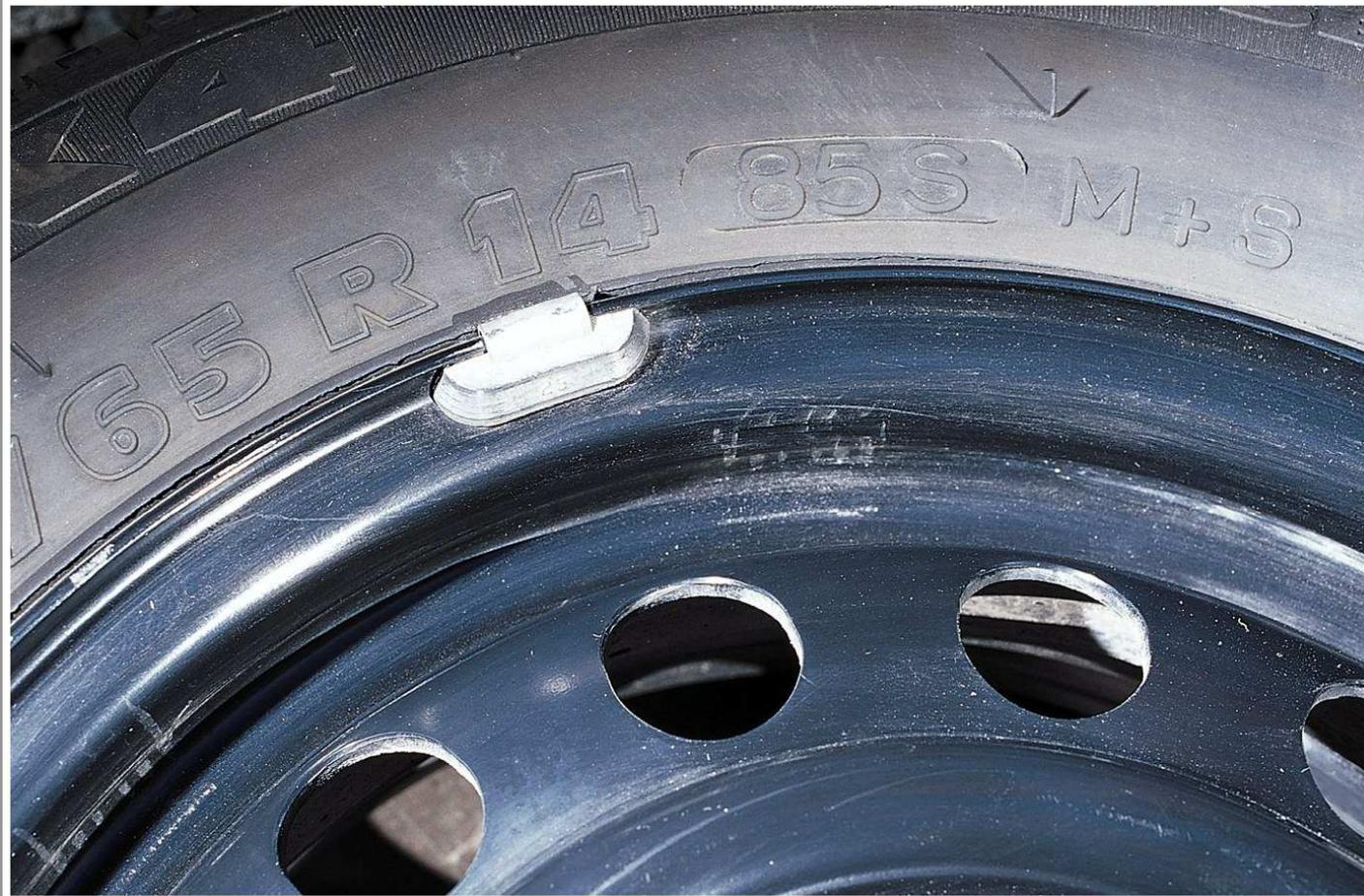
En las llantas de las ruedas de los coches se colocan pesos para equilibrarlos. El objetivo es evitar las vibraciones que producirían las oscilaciones de la dirección del vehículo.
