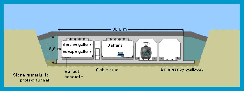
La vía contiene una autopista y ferrocarril, y consta de un tramo de puente de 6.7 Km., con estructura mixta de acero y hormigón postensado. El diseño contempla la más avanzada tecnología para garantizar una durabilidad de 100 años en condiciones ambientales muy severas. El Øresund Link también tiene un tramo en túnel sumergido de mas de 4 Km de largo, y otro tramo intermedio construido sobre una gran isla artificial.
