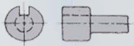
Chavetero coincide con diámetro pequeño, mal diseño
