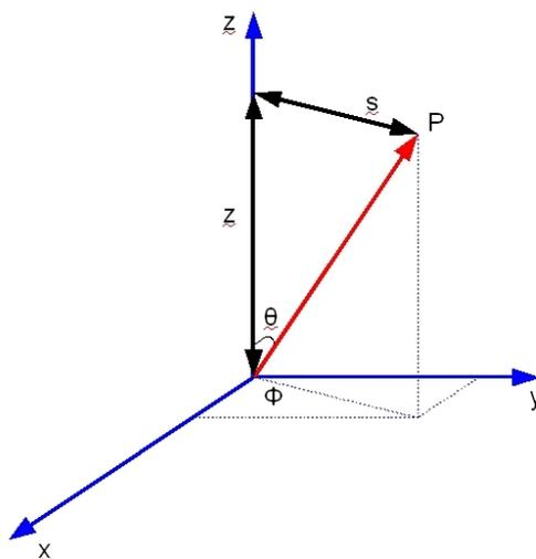
Figura 4.6: Sistemas de coordenadas cilíndricas
