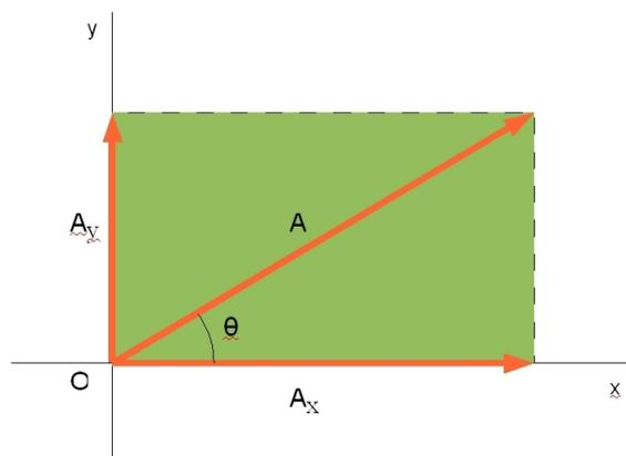
Figura 4.11: Componentes de un vector
