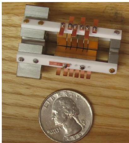
Figura 2.1: Trampa iónica, corazón del reloj de iones de aluminio desarrollado en el NIST, que tiene una precisión de 1 segundo cada 3700 millones de años (Foto: J. Koelemeij/NIST)
