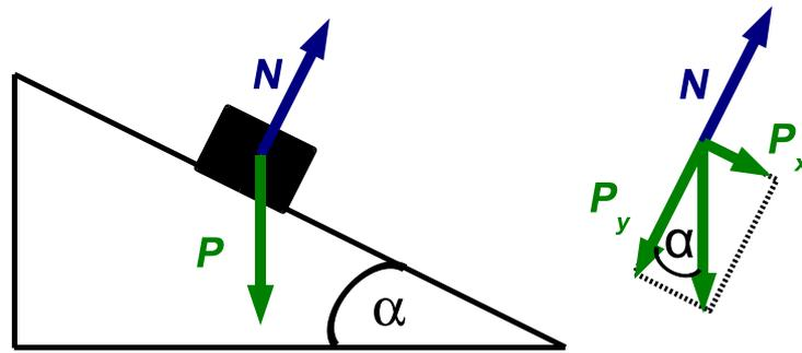
Figura 9.2: Fuerzas sobre un cuerpo sobre un plano inclinado (sin rozamiento). La fuerza normal cancela exactamente una componente de la fuerza peso, la  $P_y$ , pero la  $P_x$  producirá necesariamente una aceleración.
