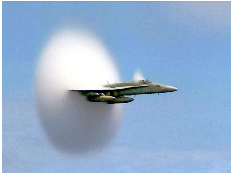
Figura 14.5: Condensación alrededor de un avión pasando la barrera del sonido, 1999, Foto de John Gay, US Navy ( http://www.navy.mil/view_single.asp?id=1445 )
