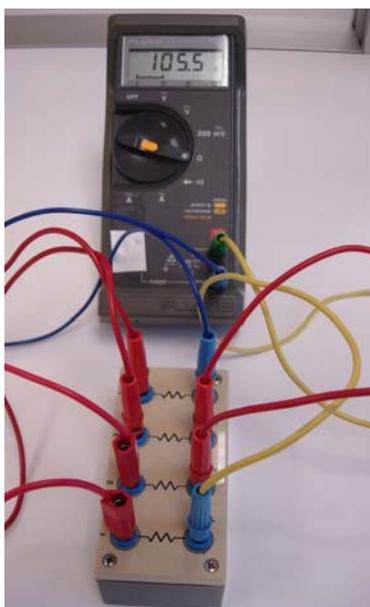
*Montaje en serie de las cuatro resistencias de la actividad anterior y su medida mediante un polímetro digital (fotografía del autor de esta unidad)*
