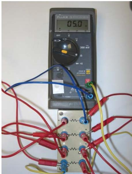
*Montaje en paralelo de las cuatro resistencias de la actividad anterior y su medida mediante un polímetro digital (fotografía del autor de esta unidad)*
