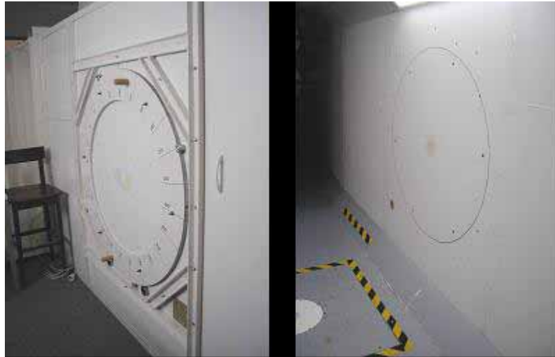
Figura B2.2. Vistas, desde fuera y desde dentro del túnel aerodinámico A9, de una de las dos plataformas giratorias en donde se posicionan los modelos para su ensayo. Estas plataformas están situadas en las paredes de la cámara de ensayos.
