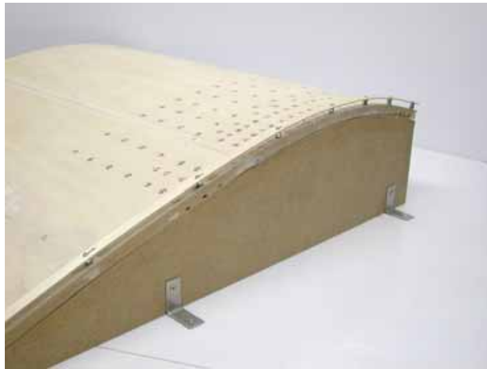
Figura B7.11. Cubierta del modelo de ensayos con el parapeto en voladizo situado sobre el borde curvo de la cubierta del mismo.
