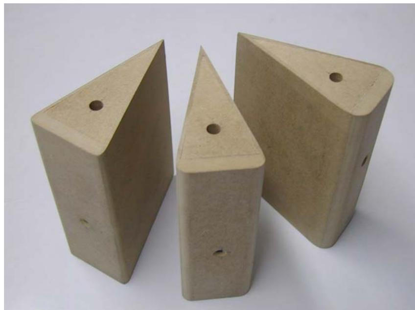
Figura C2.5. Fotografía de los modelos de prismas triangulares utilizados en los ensayos (prismas con bordes redondeados).
