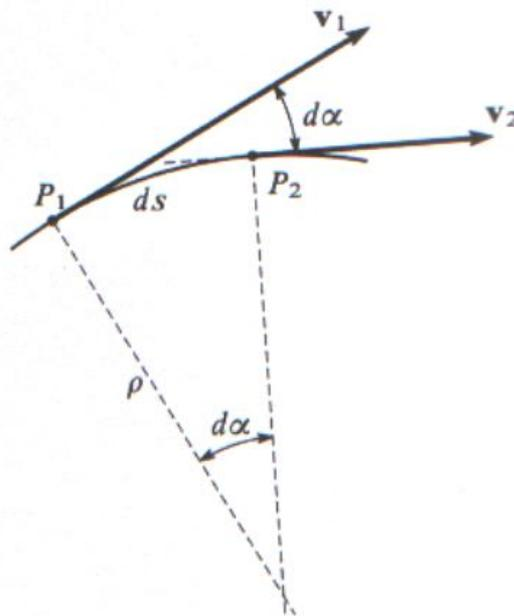
Y gráficamente  $d\bar{u}_t = \bar{u}_{2t} - \bar{u}_{1t}$  se calcula de la siguiente manera:
