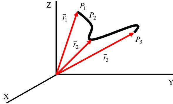
Un movimiento es *rectilíneo* cuando su trayectoria es una recta, *circular* si es una circunferencia y, en general, *curvilíneo* si es una curva cualquiera. Si puede encontrarse un sistema de referencia para el cual una de las componentes del vector de posición sea nula en todo instante se dice que se trata de un movimiento *plano*.
