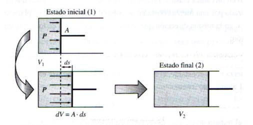
El módulo de la fuerza ejercida por el gas sobre el émbolo es PA. Si el émbolo se desplaza una distancia dx, el trabajo realizado por el gas sobre el émbolo vale:
