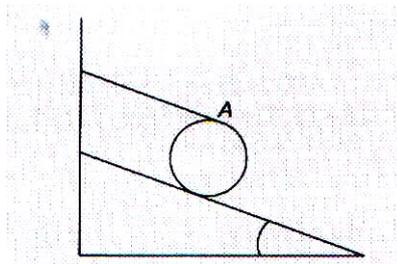
**Problema 4.** Determinar la máxima inclinación que puede tener un plano inclinado para que descienda rodando por él: a) un aro de radio  $r$  y un disco del mismo radio. Suponer que el aro y el disco son del mismo material y que el coeficiente de fricción estática con el plano es  $\mu$ .
