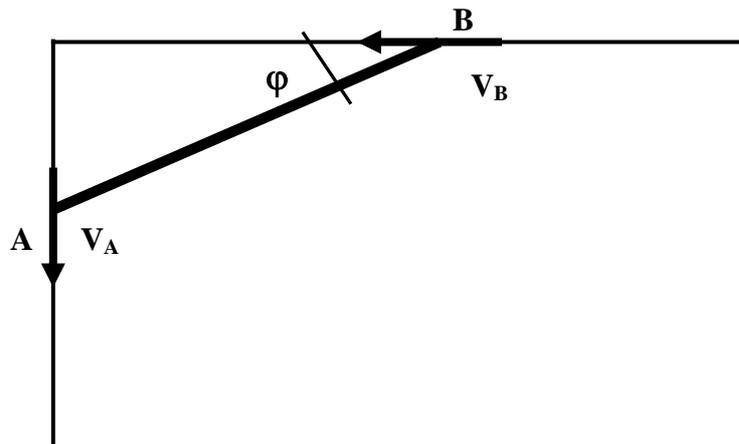
**Solución:** a)  $CIR(2L \cos \varphi, 2L \sin \varphi)$ ,  $I_{CIR} = \frac{4}{3} mL^2$ ; b)  $\bar{\omega} = \sqrt{\frac{3g \sin \varphi}{2L}} \vec{k}$ ; c)  $v_B = \sqrt{6gL}$ .
